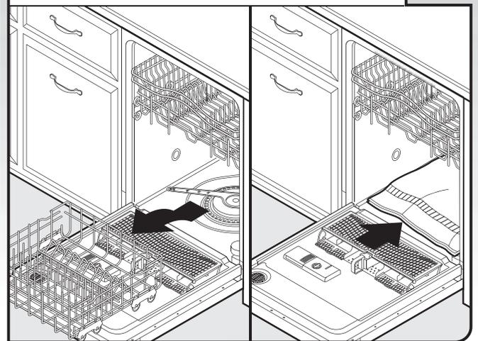
Ouvrir la porte du lave-vaisselle; retirer le panier inférieur; placer une serviette par-dessus la pompe et la rampe d'aspersion inférieure; ceci empêchera une vis qui tomberait durant l'opération d'arrimage de s'introduire dans la zone de la pompe.
